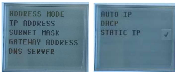
Pressione o botão Esc para sair, e depois selecione IP ADDRESS. Atraves das setas verticais, altere os valores do IP, para mudar de numero a ser ajustado. Ajuste para um endereço conhecido que depois será ajustado também no Easysoft7, e na mesma camada de IP fixo do computador. Exemplo: 192.168.1.5
