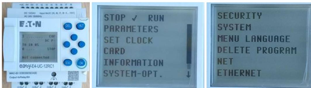
No menu Ethernet, selecione Address Mode. Mude de Auto IP para Static IP. Se o Easy estiver em Run, será necessário muda-lo para Stop, parando temporariamente seu funcionamento.
