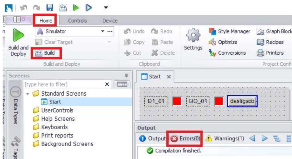
Para simulação, selecione a conexão Simulator, e depois clique em Build and Deploy. Surgirá então um campo que é a animação da tela, onde se pode simular diferentes situações, como botões, sinaleiros, trocas de telas. As variáveis que trocam dados diretamente com o CLP ou outros dispositivos podem apresentar erros, pois na simulação não se tem a rede.
